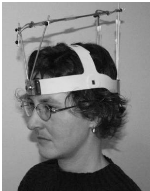
Obrázek 80 Diody upevněné na elastickém pásu na hlavě (Tyronová, Mauk 2010, s. 19)
