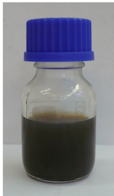
Obr. 9: Hexanová suspenze nanočástic zinkem dopovaného kobaltnatého feritu, jeden z produktů připravených termální dekompozicí.
