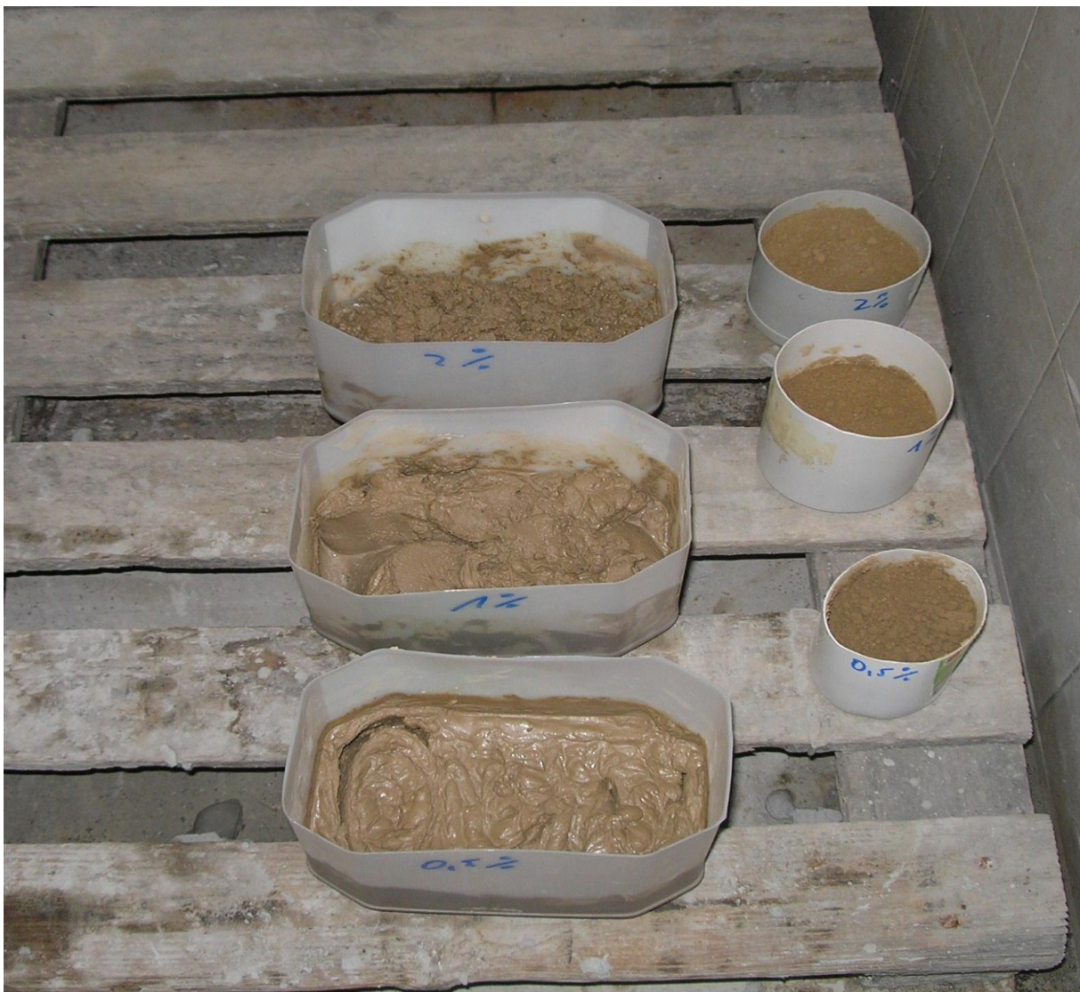
Obr. 15 - Vzorky ve zrací místnosti. Za povšimnutí stojí různý vzhled past odpovídající různému dávkování vápna, odspoda 0,5, 1 a 2 % CaO. ( w_1 velké nádoby, w_p malé nádoby)
