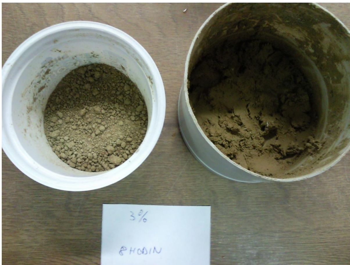
Obr. 20 - Stav zeminy se 3 % vápna po 8 hodinách zrání
