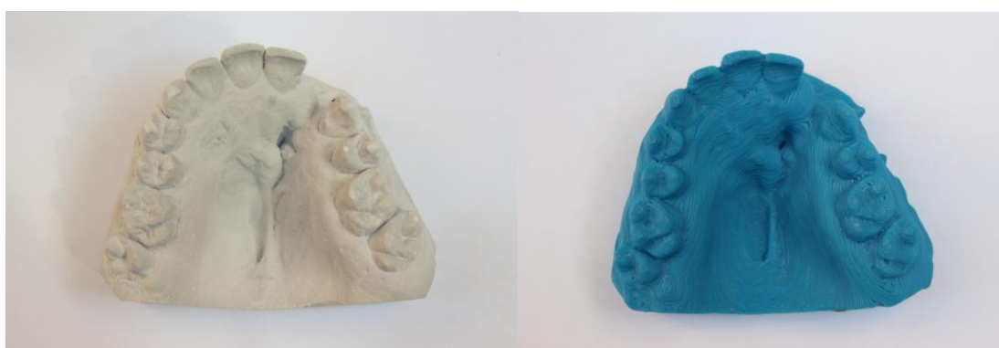
Obr. 36 : Sádrový model horní čelisti pacienta s rozštěpem alveolu a horního patra a jeho 3D tištěná kopie.
