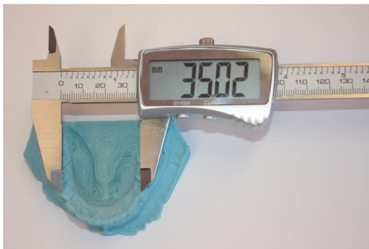
Obr. 35: Měření digitálním posuvným měřítkem na modelu získaném 3D tiskem.
