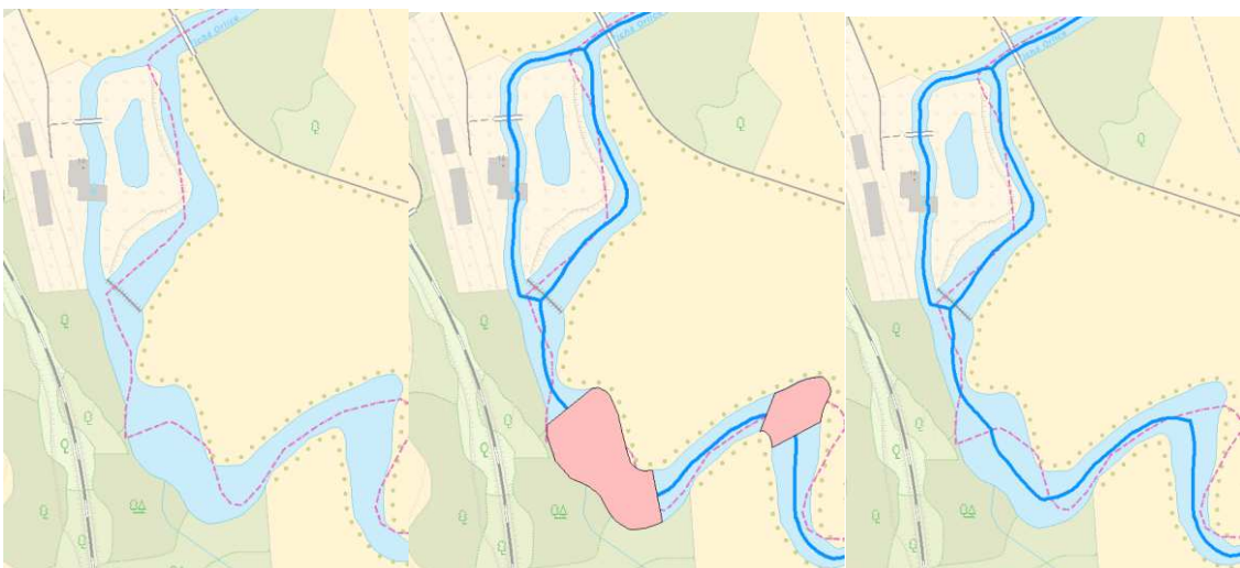
Obr. 82 Rozšíření a ostrov w_{max} = 30 m, úplná generalizace vodního toku, reprezentace linií.
