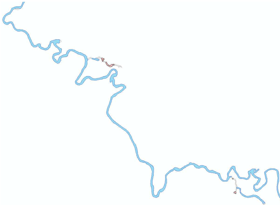
Obr. 72 Čtvrtá část vodního toku s nastavenou hodnotou kritéria w_{max} = 15 m, úseky se zachovanou reprezentací břehovkami na základě w_{max} (červeně) a úseky se zachovanou reprezentací břehovkami po aplikaci doplňkových kritérií (modře).
