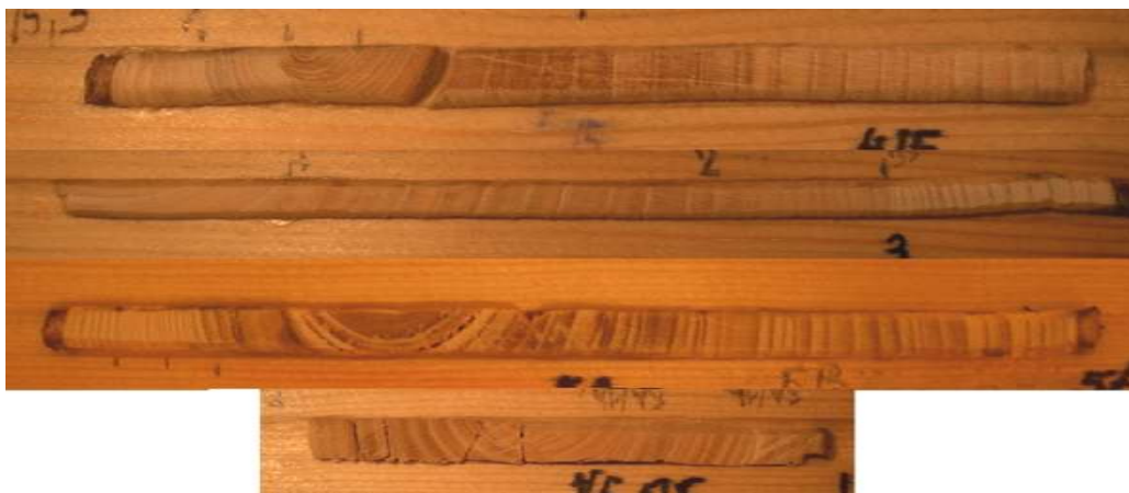
Obrázek 13. Analyzované vývrty (odshora) 1, 2, 5B a 5A (fotografovány v nestejných měřících)
