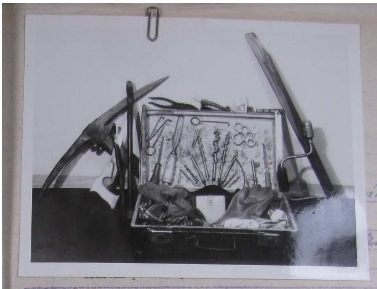
Obrázek 19: Náčiní zloděje. Šperháky, krumpáč, rukavice, vrtáky na pokladny, paklíče apod. Zdroj: Archiv bezpečnostních složek
