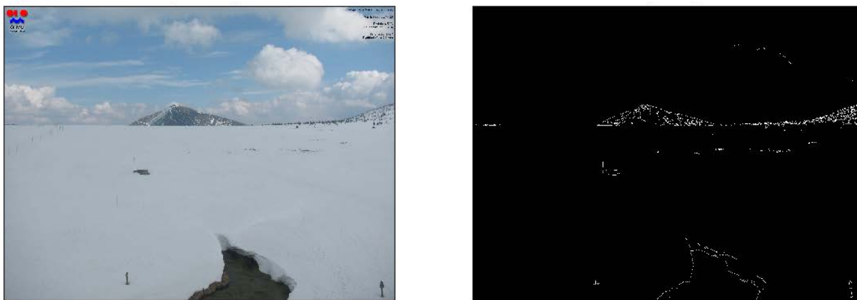
Obrázek 25: Aplikace Cannyho hranového detektoru; vlevo před aplikací; vpravo po aplikaci – bílé pixely hran Zdroj: Autor, ČHMÚ
