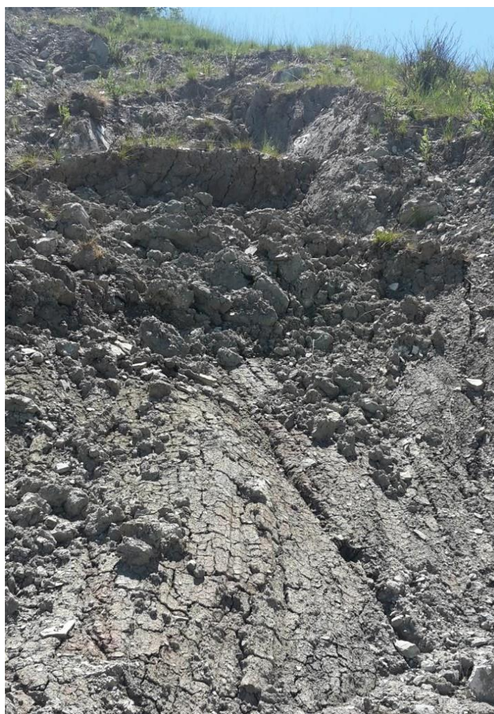
Obrázek č. 5 - Zdrojová a transportní zóna rotačního sesuvu. foto: Petr Fišer
