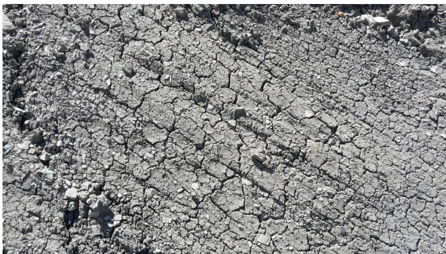
Obrázek č. 6 - Detail skluzné plochy rotačního sesuvu. foto: Petr Fišer
