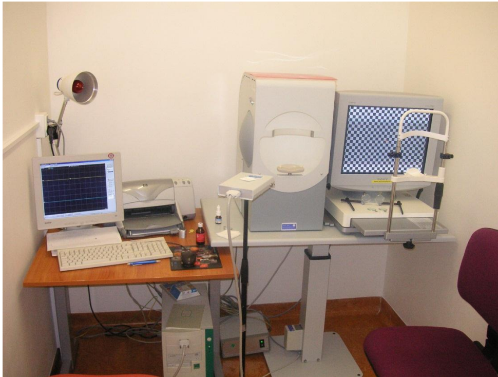
Obr. č. 21. Elektrofyziologická jednotka Reti-port (zleva doprava: monitor, klávesnice, tiskárna, počítačová jednotka, předzesilovač, polokoule pro difuzní zábleskovou stimulaci a monitor pro stimulaci strukturovanými podněty)
