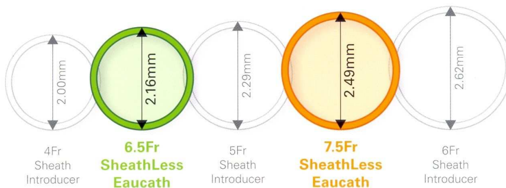
Obrázek č.29: Srovnání zevních rozměrů 4-6 sheathů se zevními rozměry vodících katetrů Sheathless 6,5F a 7,5F, jejichž vnitřní rozměr umožňuje zavedení podstatně většího instrumentaria než je možné přes uvedené sheathy
