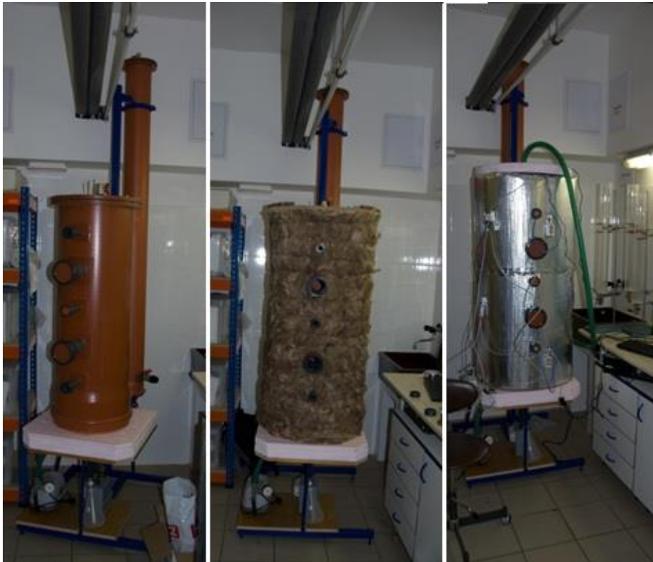
Obr. 5: Bioreaktor na biosušení separátu (Pilnáček, 2014).
