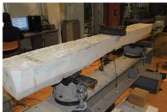
Slika 10. Statičko ispitivanje središnjega presjeka na negativan moment
