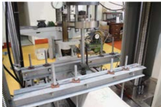
Slika 28. Vlačno ispitivanje plastičnih uložaka
