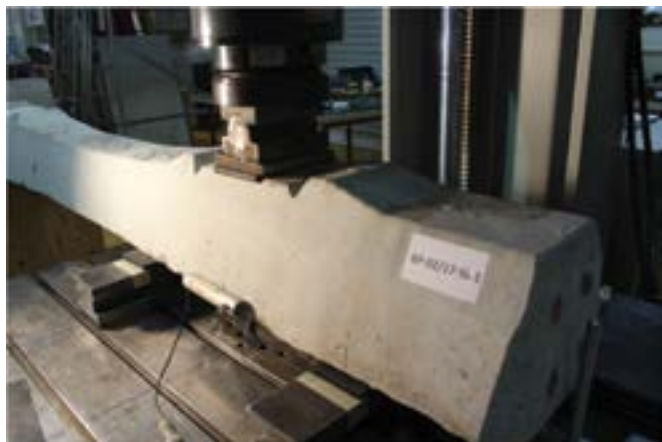
Slika 4. Statičko ispitivanje na mjestu ležišta tračnice
