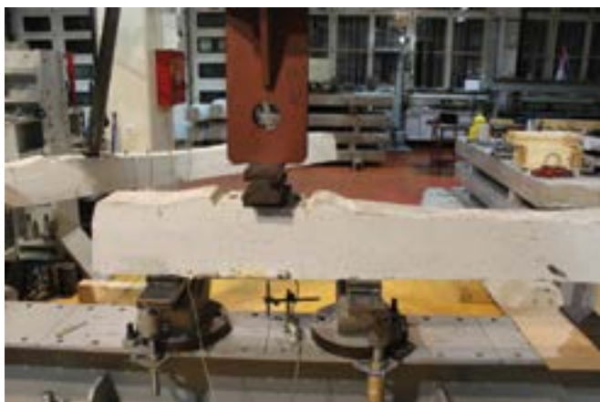
Slika 21. Ispitivanje presjeka na mjestu ležišta tračnice na zamor
