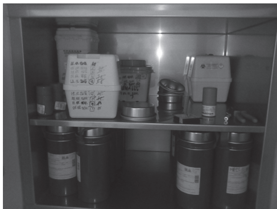
Slika 1. Olovni ormar za pohranu istrošenih radionuklidnih generatora (fotografija: Smojver, D., 2017.) Figure 1. Lead cabinet for storing used radionuclide generators, author D. Smojver, 2017
