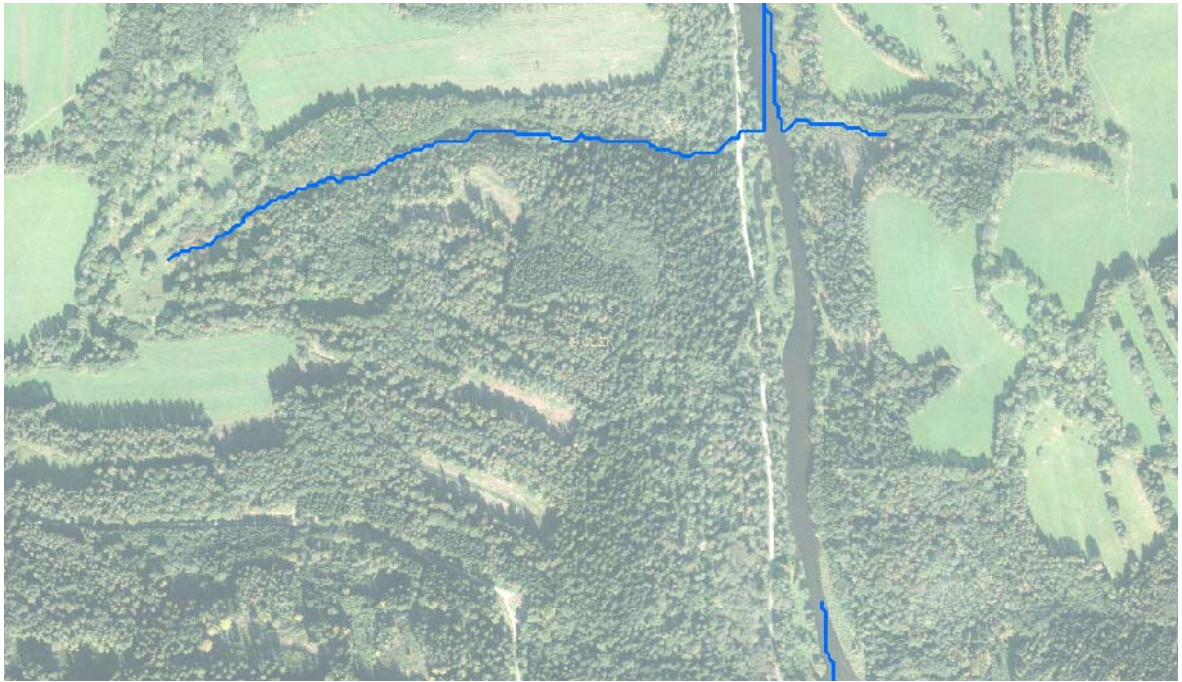
Obr. 9 Přerušení vodního toku v lokalitě Rožmitál v místě širokého koryta řeky Vltavy. Modrou barvou jsou znázorněny vodní toky ArcHydro.
