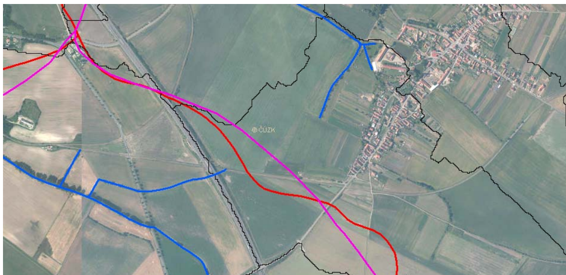
Obr. 13 Linie rozvodnic a vodních toků v části území lokality Říp. Černé linie představují rozvodnice ArcHydro, které jsou vedeny podél dálnice D8 vystupující nad terén. Červenou barvou jsou znázorněny rozvodnice DIBAVOD, růžovou barvu představují rozvodnice ČHMÚ. Tyto rozvodnice jsou vykresleny nad vrstevnicemi a nedbají na dálnici vedoucí uprostřed snímku. Modrou barvou jsou zobrazeny vodní toky DIBAVOD.
