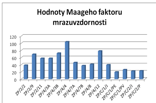
Obr. 18. Rozsah hodnot Maageho faktoru mrazuvzdornosti pro studované vzorky cihel z ohradní zdi Zemské porodnice v Praze.
