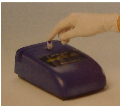
Obrázek č. 5: Měření blanku
