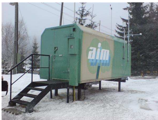
Obr. 2: Kontejner automatizovaného imisního monitoringu na stanici Souš (Int.6).
