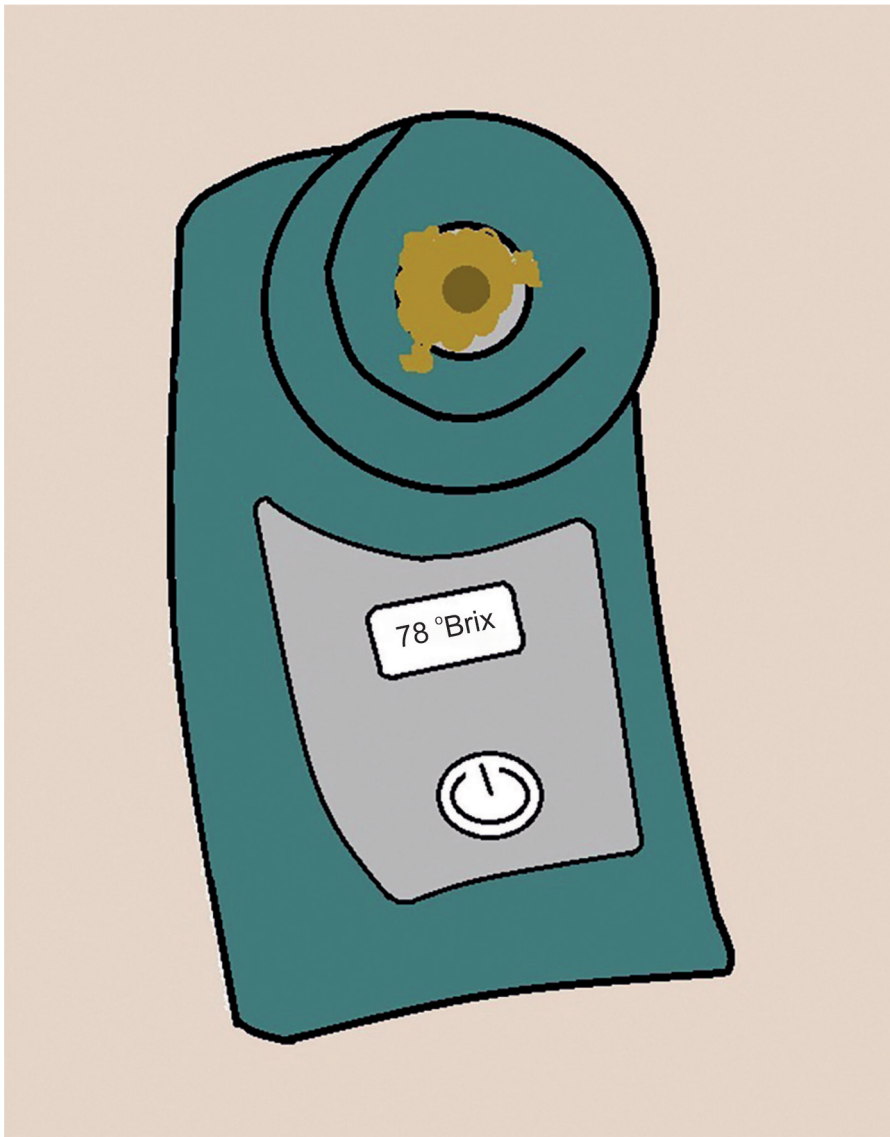
Figura 5. Determinação do ponto final do doce de umbu através do refratômetro.
