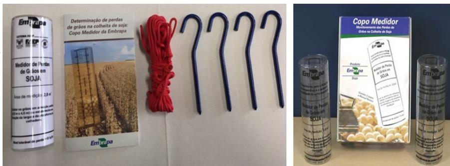
**Figura 1.** Conjunto com copo medidor Embrapa, manual de uso, armação em barbante e pinos de fixação ao solo usados para determinar a área amostral.
