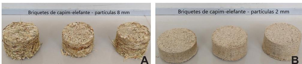
**Figura 4.** Briquetes de capim-elefante variedade Madeira obtidos a partir de biomassa com granulometrias de partículas de 8 mm (A) e 2 mm (B). Rio Largo, AL, 2020.
