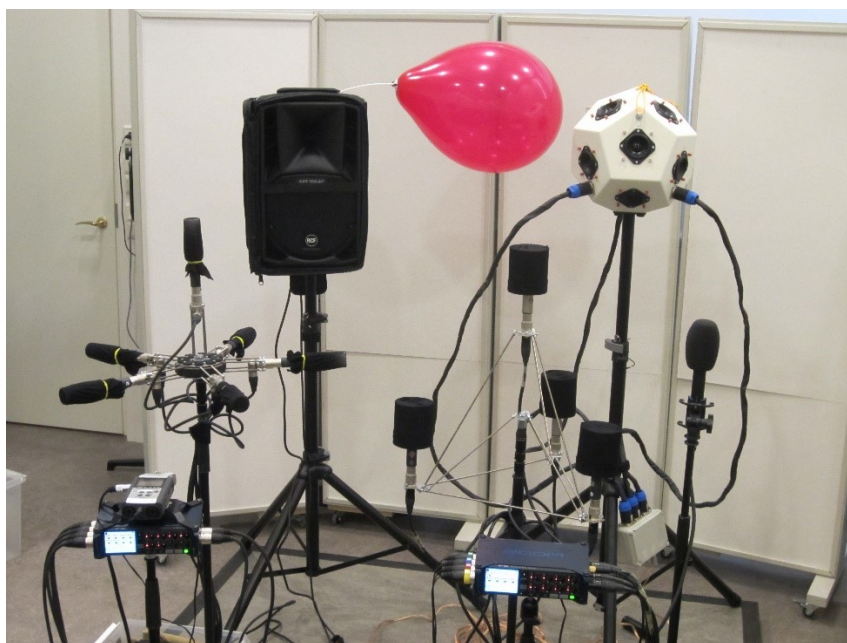
Kuva 5: Kenttätyöäänityskalusto yhteiskuvassa riveittäin vasemmalta oikealle: ylhäällä herätelähteet ART 708-A, lateksi-ilmapallo ja dodekaedrikaiutin, keskellä kuusikanavamikrofonihila (vas.) tetraedrimikrofoni ja Ambeo VR -mikrofoni, alhaalla Zoom H4n ja F8 -tallentimet.
