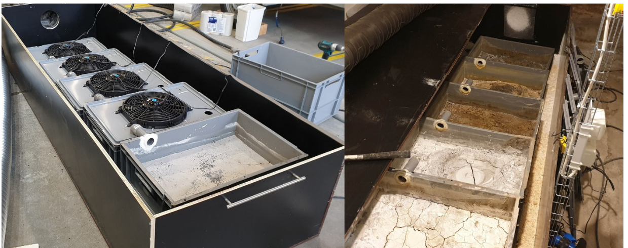
Kuva 8. Vasemmalla Sanitation 360® pilottikokeilun alussa ja oikealla tuhka-kalkkiseosta sisältäneet laatikot käsittelyn lopulla. Kuvat: Prithvi Simha/SLU.
