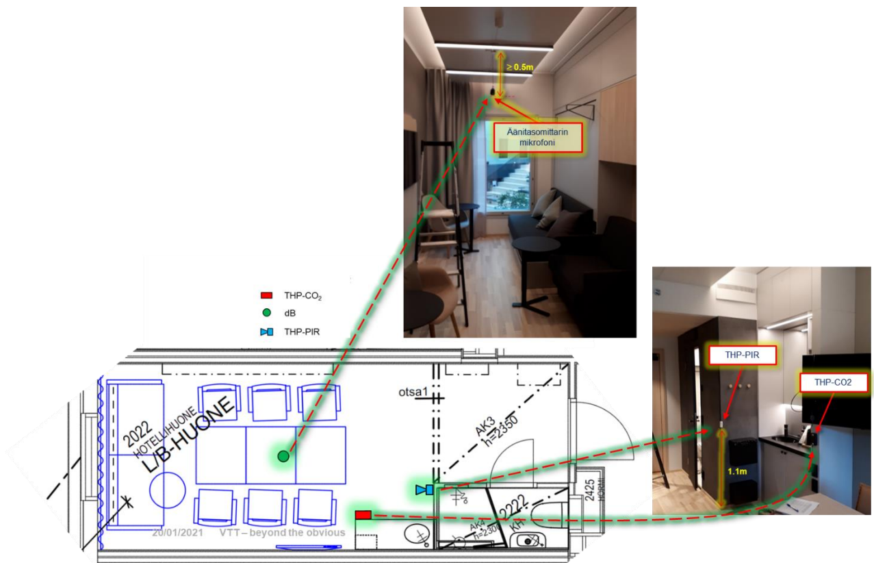
Kuva 3: Esimerkki olosuhdemittauksessa käytettyjen antureiden sijoittelusta huoneessa.
