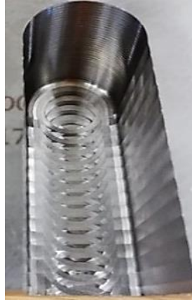
Figure III.17 : Surface générée par l'outil AJX ( kr > 90^\circ )
