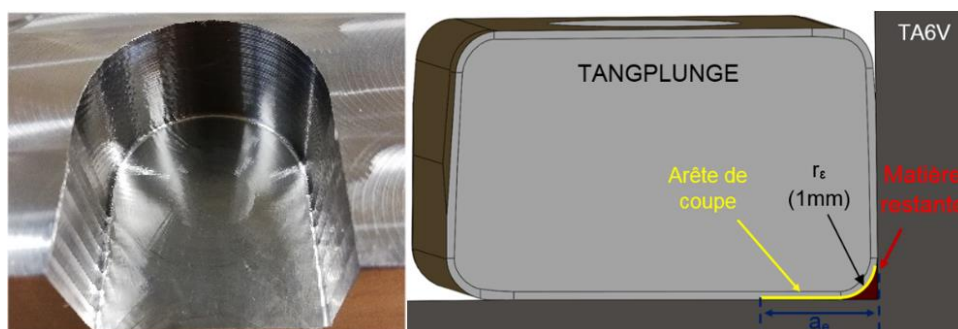
Figure III.2: Géométrie et surface usinée générée par l'outil TANGPLUNGE d'Iscar ( kr = 90^\circ )
