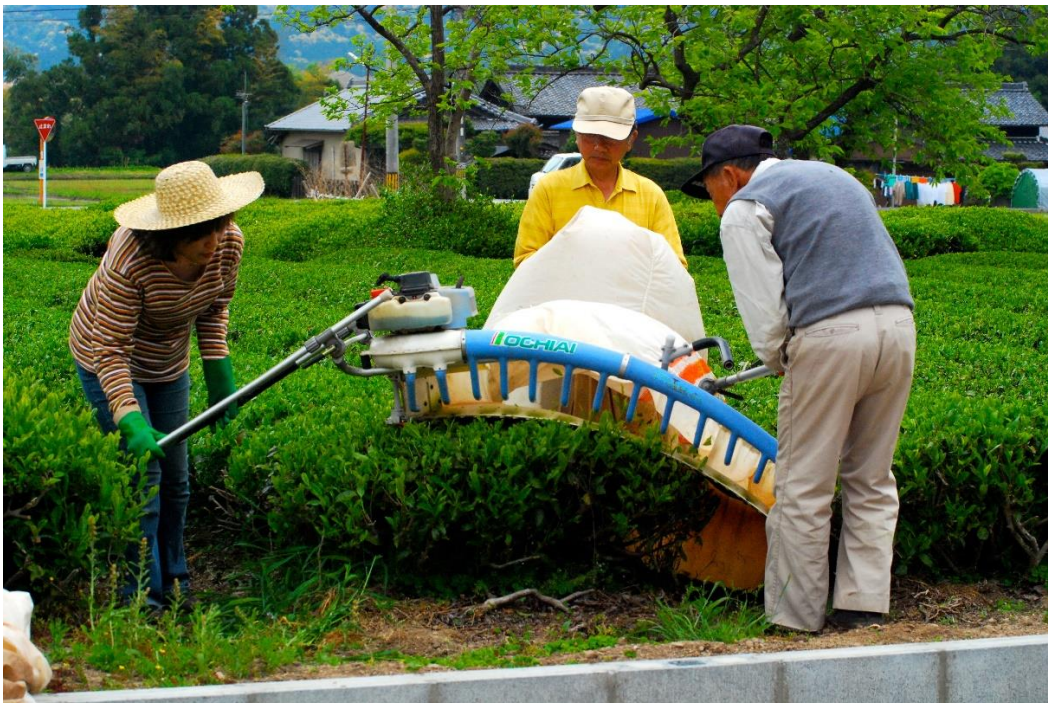
Figur 5. En skördemaskin för två personer bestående av en krökt häcksax och luftmunstycken som blåser tebladen in i den uppsamlade påsen. (Studholme 2009) (CC BY 4.0)
