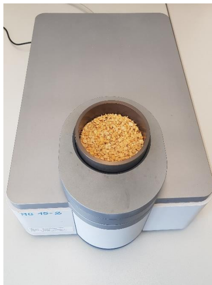
Abbildung 2: Vermessung einer Sojabohnenprobe mit dem FT-NIR-Spektrometer Tango (Bruker Optics)
