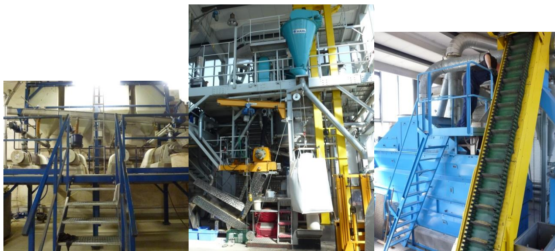
Abbildung 28: Entölung mittels Schneckenpressen bei der Firma Meika
