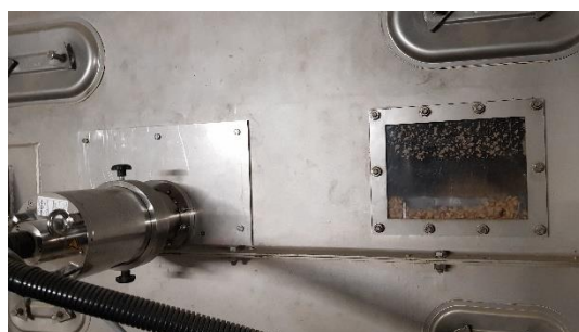
Abbildung 5: Eingebauter NIRS-Sensor in der Prozessstrecke im Bereich des Wirbelstromtrockners
