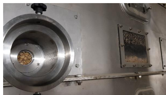
Abbildung 6: Blick auf das Substrat hinter dem NIRS-Sensor in der Prozessstrecke im Bereich des Wirbelstromtrockners
