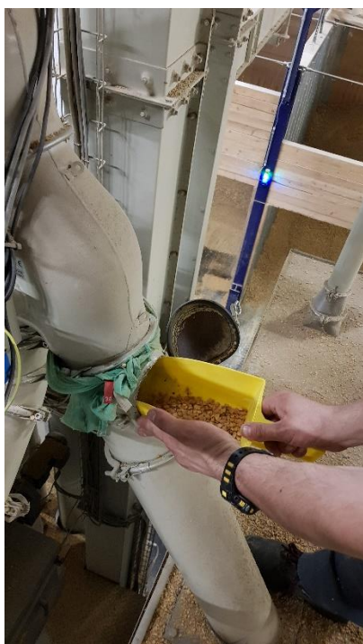
Abbildung 25: Entnahme von behandelten Sojabohnen aus der Prozessstrecke einer dezentralen Aufbereitungsanlage
