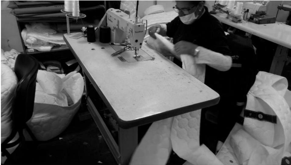
*Ilustración 12.* Máquina Plana. Fuente: Autores
