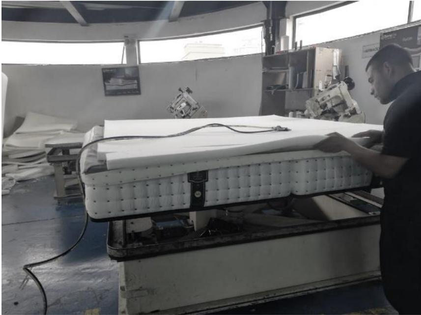
*Ilustración 14.* Máquina cerradora. Fuente: Autores
