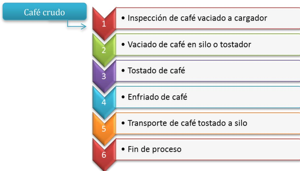
**Figura 25:** Diagrama de Operaciones en el proceso del Tostado de Café
