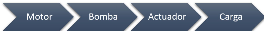
FIGURA 8 Proceso de transformación de la energía en un sistema hidráulico 8
