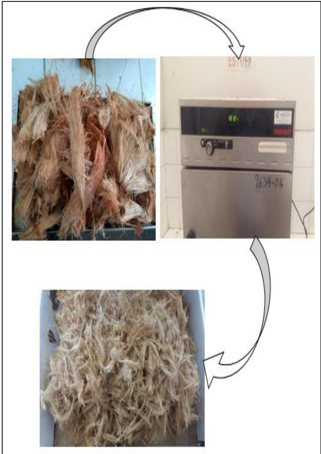
Figura 9.1. Proceso de secado de la fibra de coco. Elaborado por los autores.
