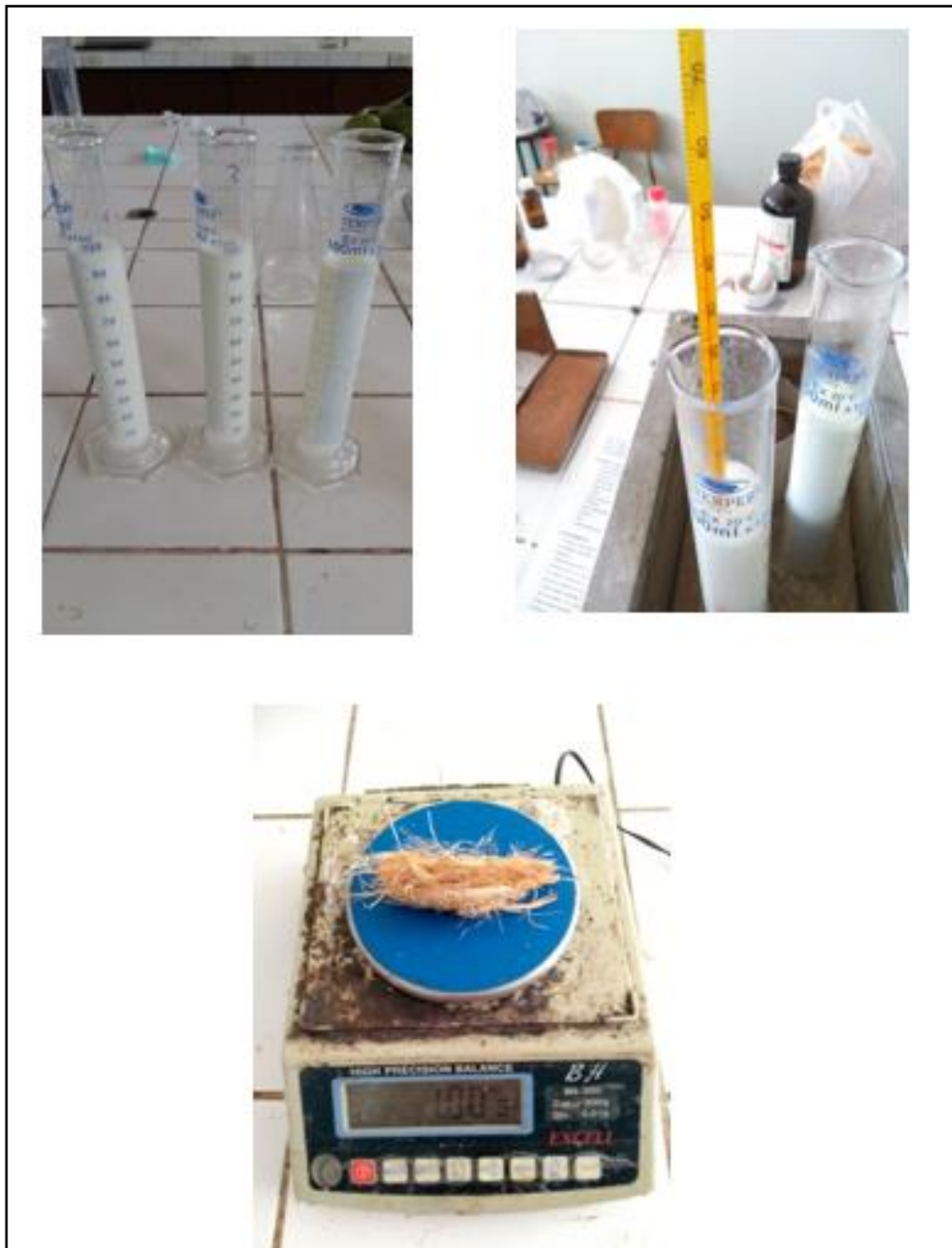
Figura 9.3. Proceso de acondicionamiento de muestra agua- hidrocarburo y de la muestra de fibra de coco. Elaborado por los autores.
