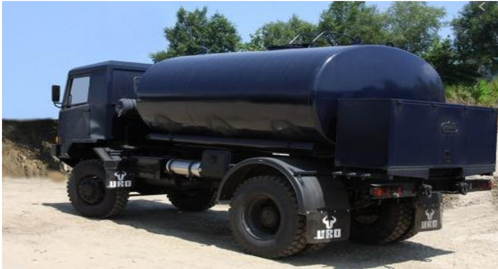
Figura 8. Cisterna para el transporte del agua potable. Adaptado de Agrícola Cerro Prieto
