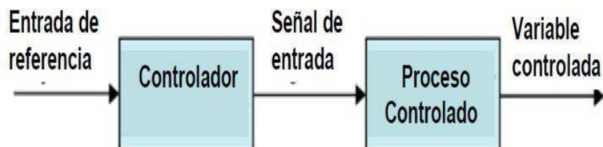
Figura 1: Sistema de Control en Lazo Abierto
