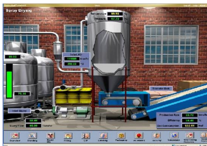
Figura 8: Ejemplo de una pantalla en Scada Factory Talk.
