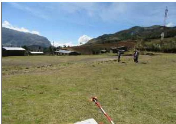
DESCRIPCION FOTO N°: SE TOMA LA DISTANCIA CADA 20 METROS PARA LA RESPECTIVA COLOCACION DEL PRISMA 7
