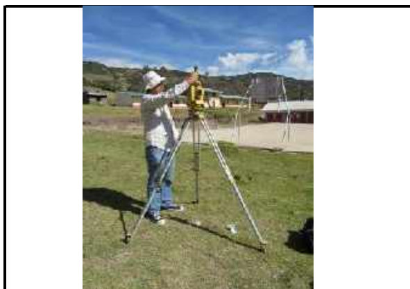
DESCRIPCION FOTO N°: SE OBSERVA QUE SE TOMA COORDENADAS PARA EL RESPECTIVO USO DEL EQUIPO TOPOGRÁFICO 5
