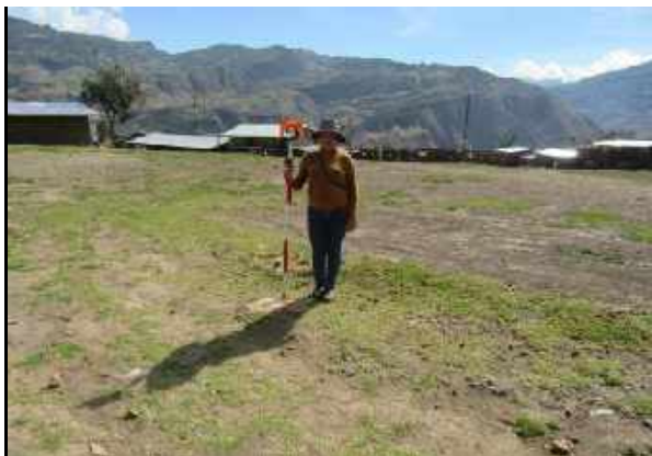
DESCRIPCION FOTO N°: COLOCALDO EL PRIMA PARA DAR LECTURA CON LA ESTACION 6
