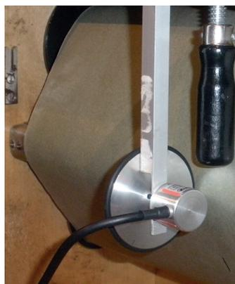
Bild 70 – Wegmessung auf dem pneumatischen Bandspielapparat
