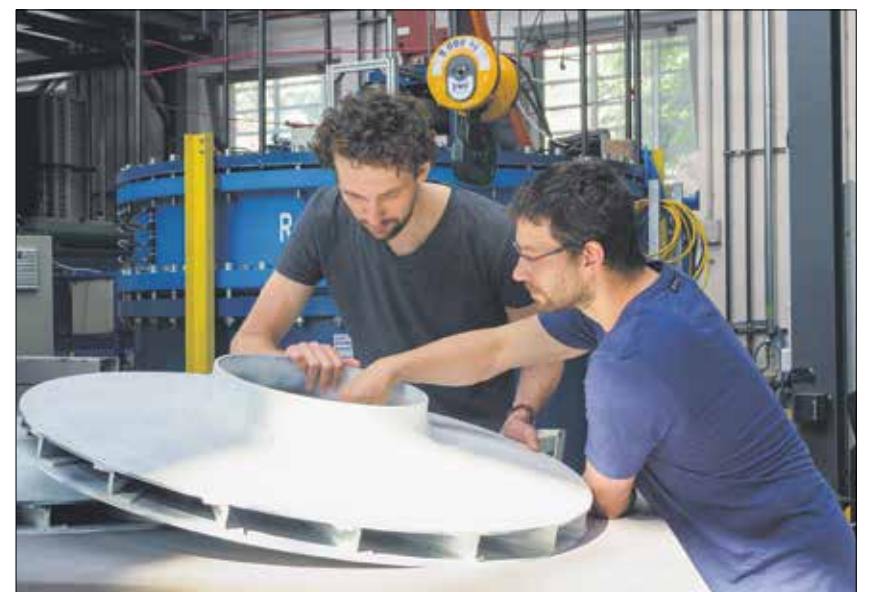
Sebastian Spitzer (l.) und Martin Pohl, Wissenschaftler des Projektteams, prüfen das Faserverbund-Laufrad vor dem Einbau in den Rotationsprüfstand.
