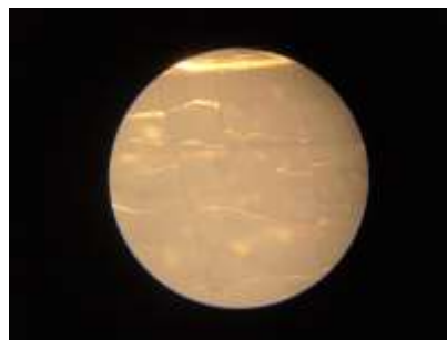
図4 顕微鏡で観察されたUV-B照射後のPE表面の様子
