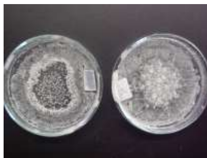
図3 UV照射後のPEの様子(左;UV-A,右;UV-B)
