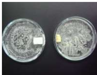
図2 UV照射後のEPSの様子(左;UV-A,右;UV-B)
