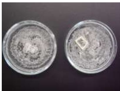
図5 UV照射後のPETの様子(左;UV-A,右;UV-B)
