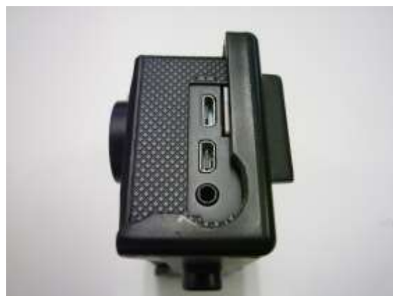
写真9 外部マイク端子付近を削って上げた様子
