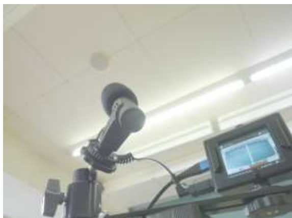
写真7 天井スピーカに向けた外部マイク
