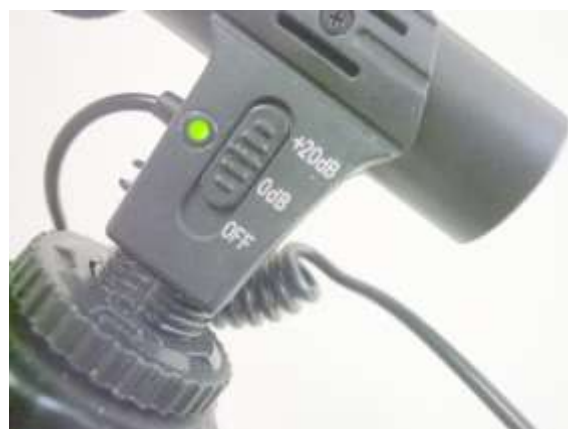
写真10 外部マイクのスイッチと緑色LED
