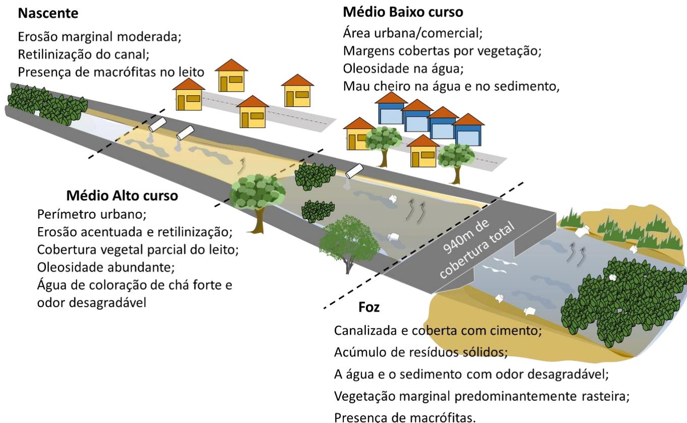
Figura 5 - Desenho esquemático do Córrego Sangradouro demonstrando da Nascente até a sua Foz. Os trechos são diferenciados pela linha preta tracejada. Setas na água indicam odor forte. Manchas na água representam oleosidade. Retângulo cinza paralelo ao curso d'água indicam a canalização. Construções em colorações diferentes denotam região residencial e comercial. Mancha marrom na Foz indica ausência de canalização e presença de solo exposto com algumas gramíneas.
