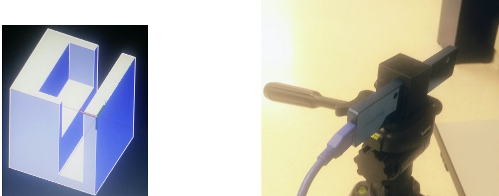
Figura 3.6: A la izquierda esta la pieza invertida para mejor visualización del interior y a la derecha como queda ya colocada.
