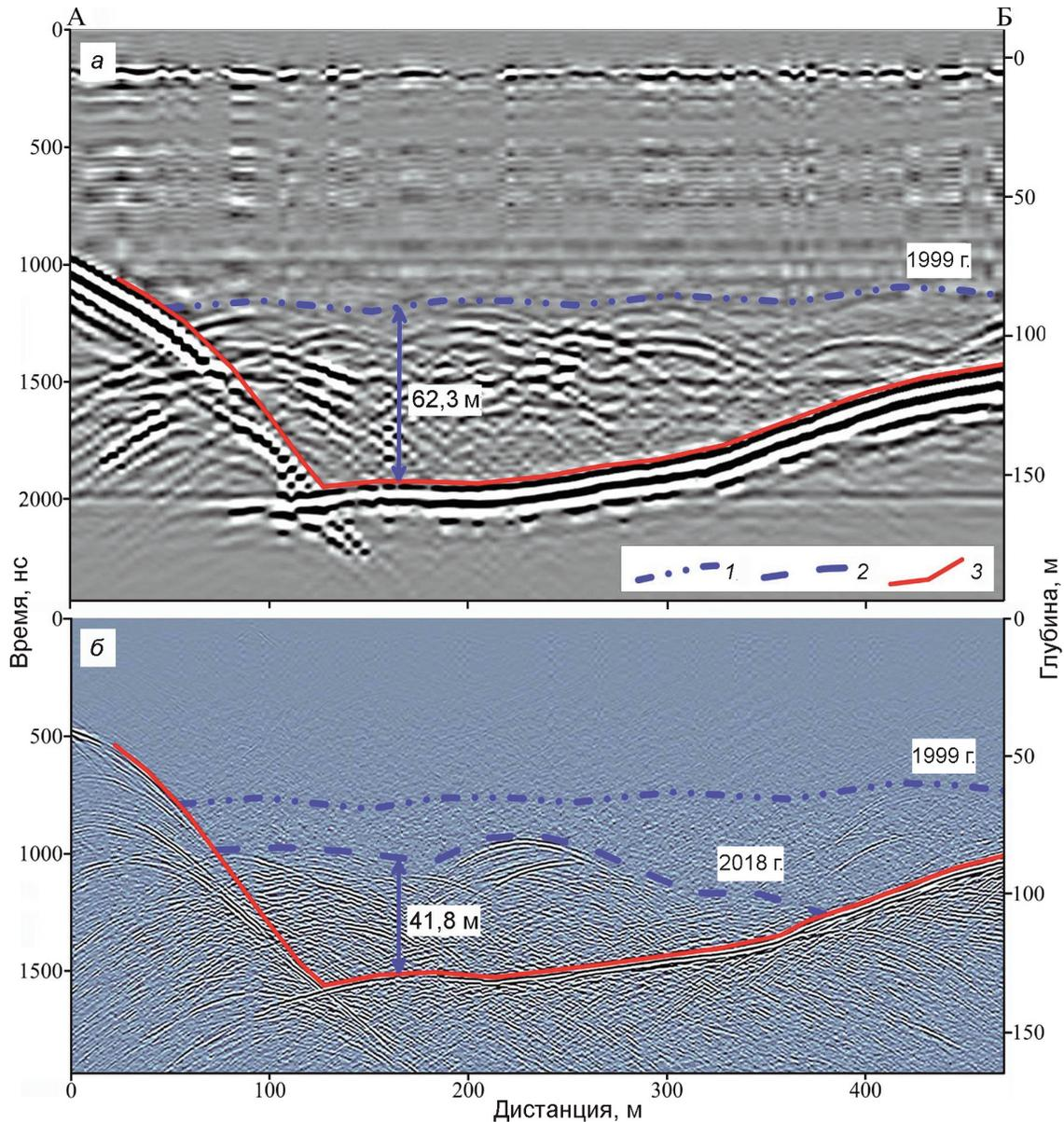
**Рис. 6.** Сопоставление радарограмм 1999 (а) и 2018 гг. (б) на близко расположенных участках профилей (см. рис. 1). 1 – положение верхней границы тёплого льда в 1999 г. по измерениям локатором ВИРЛ-2 на частоте 40 МГц; 2 – положение верхней границы тёплого льда в 2018 г. по измерениям локатором PulseEKKO PRO на частоте 50 МГц; 3 – положение ложа ледника
