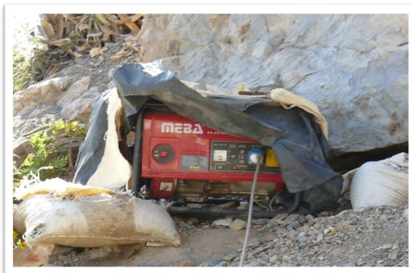
Fig. 7: Motor utilizado para accionar el martillo eléctrico en las actividades mineras de la asociación.
