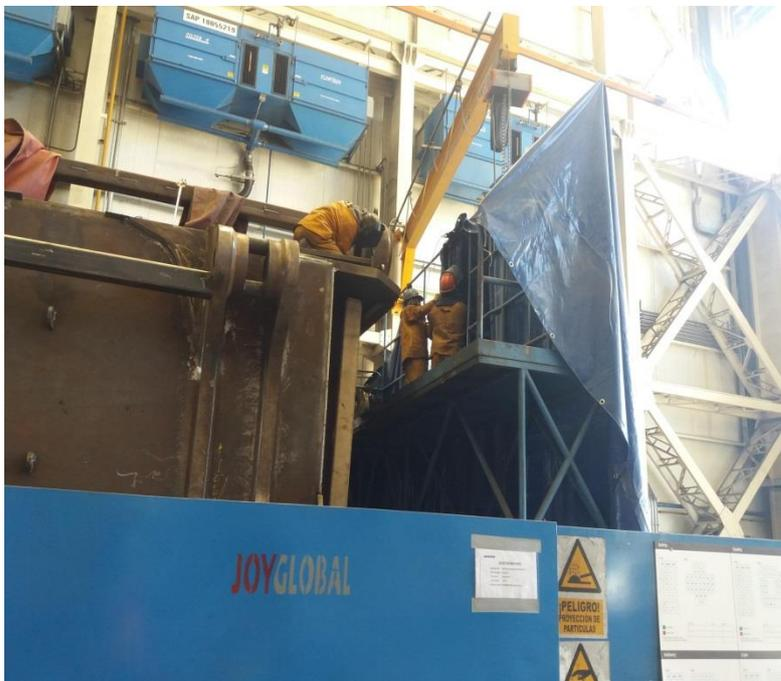
Operarios soldadores realizan soldeo en parte superior de componente (Dipper) con una altura promedio de 5.4 m.
