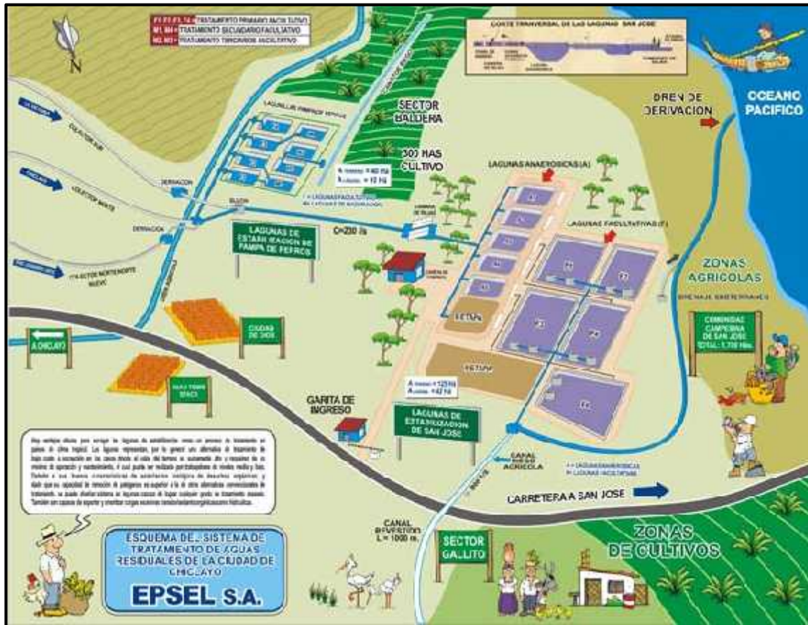
Figura 9. Sistema de Tratamiento de aguas residuales
