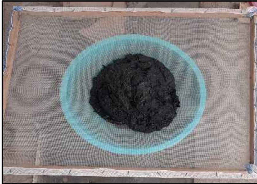
Figura 21. Lodo residual secado al aire libre
