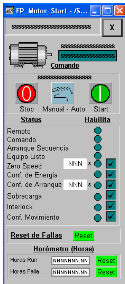
FIGURA 73: FACE PLATE DE ARRANQUE DIRECTO DE MOTOR Fuente: Propia
