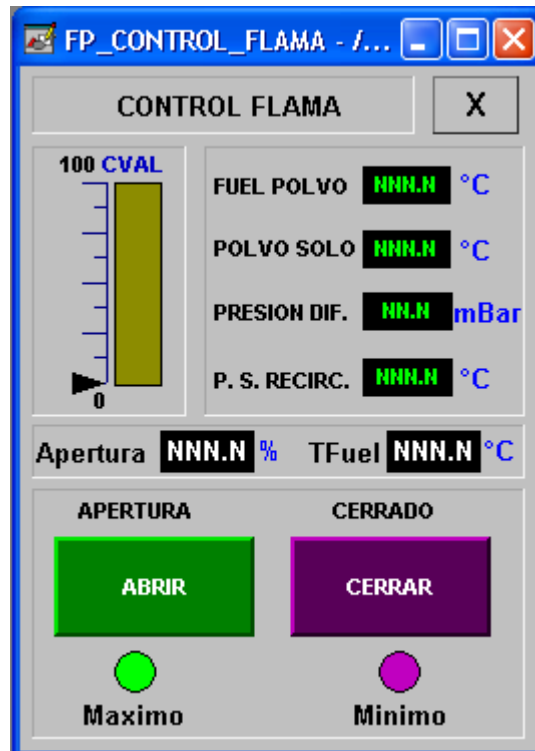
FIGURA 78: FACE PLATE PARA CONTROL FLAMA Fuente: Propia
