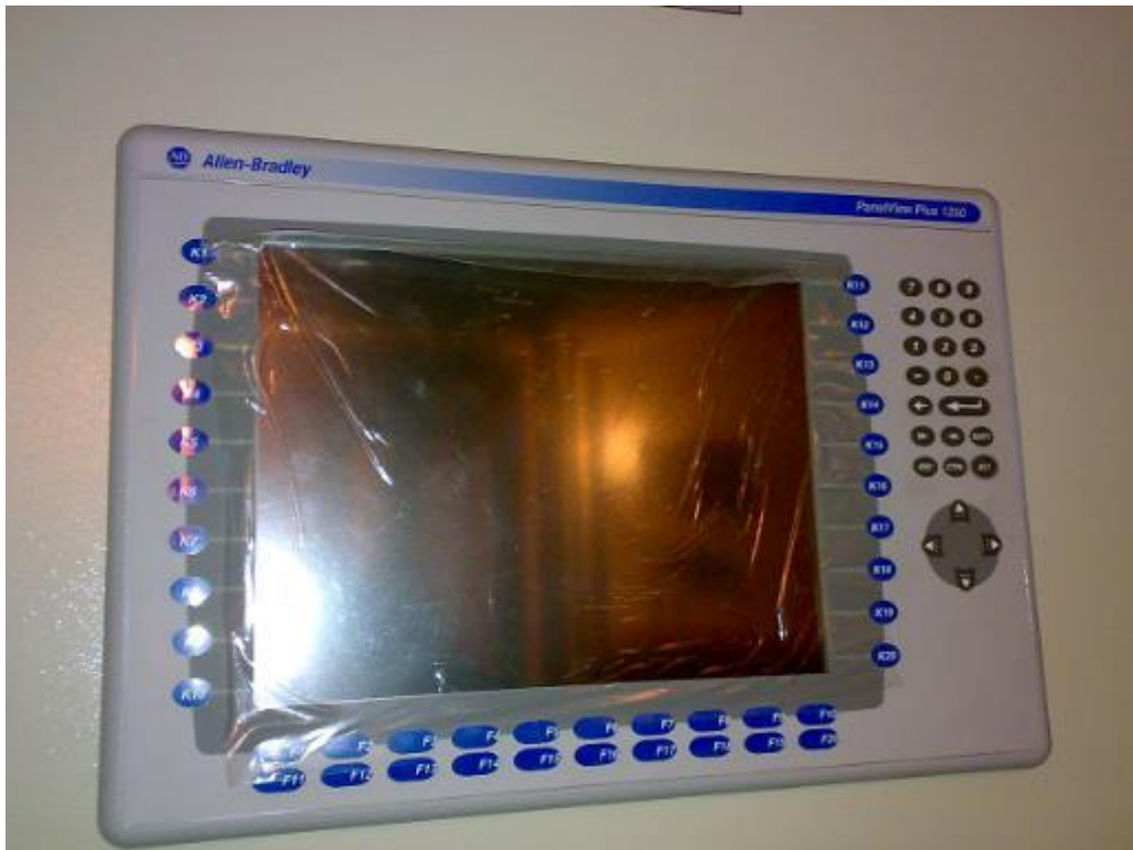
FIGURA 121: PANELVIEW PARA LAS PANTALLAS DE SUPERVISIÓN. Fuente: Propia
