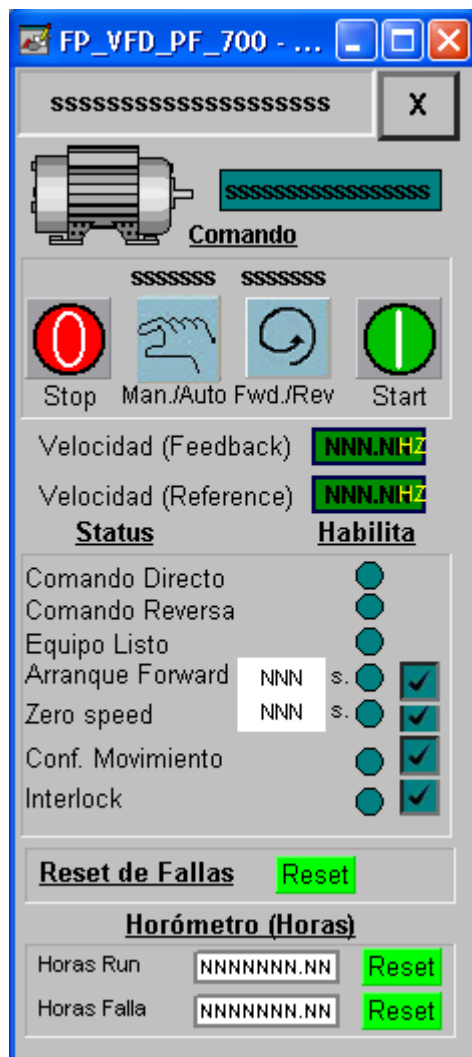
FIGURA 75: FACE PLATE DE ARRANQUE DE VARIADOR Fuente: Propia
