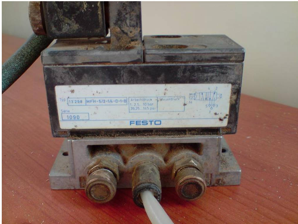
FIGURA 110: VÁLVULA DISTRIBUIDORA NEUMÁTICA ANTES DE LA AUTOMATIZACIÓN Fuente: Propia
