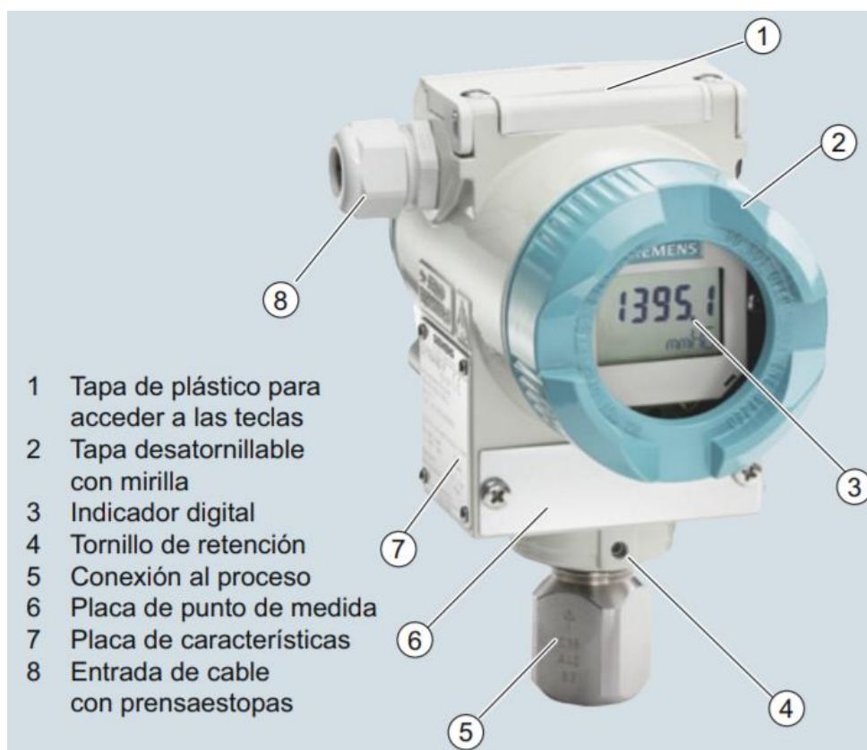
FIGURA 26: CABEZAL Y DISPLAY DEL SENSOR DIFERENCIAL DE PRESIÓN. Fuente: Ceisamx
