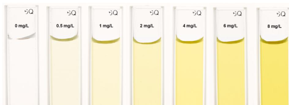
Figura 13. Escala de color con recortes en forma rectangular mostrando la celda de cuarzo
