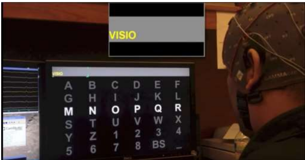
Figura 21. Sistema BCI usando el paradigma P300. Fuente: (Doc, 2013).
