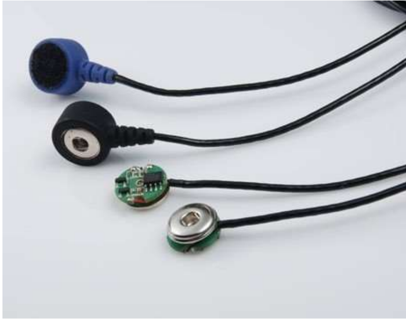
Figura 15. Electrodo EEG de característica activa. Fuente: (Co, 2019).
