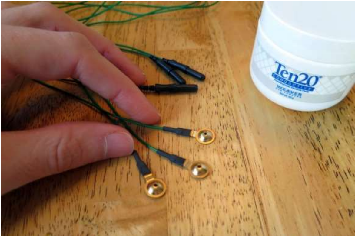
Figura 14. Electrodo EEG tipo Pasivo tipo disco, reutilizable de plata recubierto en oro.
