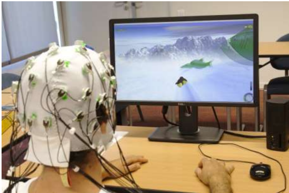
Figura 16. Uso de Brain Computer Interface el cual presenta electrodos de característica Activa. Fuente: (POTIOC, 2019).
