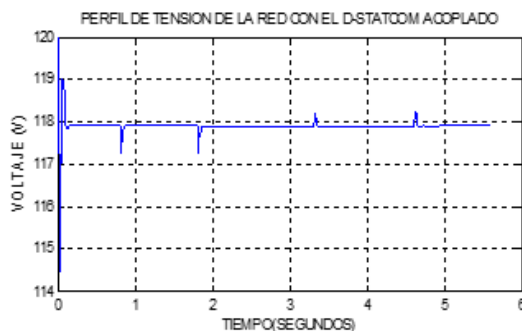
Figura 17: Perfil de tensión de la red con el D-STATCOM acoplado. Fuente: Elaboración propia.
