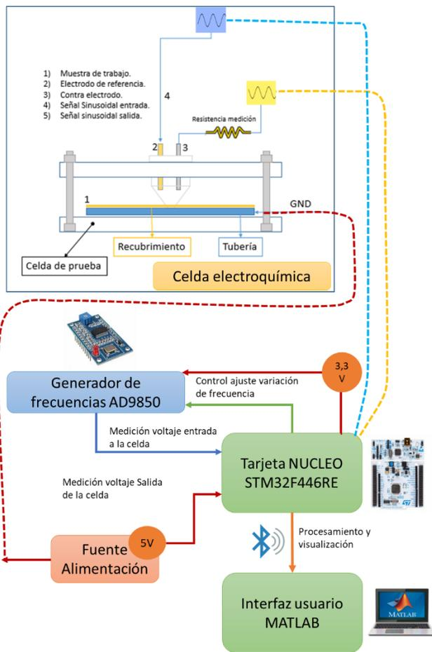
Figura 6. Configuración sistema de medición y adquisición de datos del ensayo de espectroscopia de impedancias electroquímica
