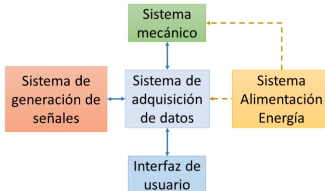
Figura 1: Arquitectura básica del prototipo.
