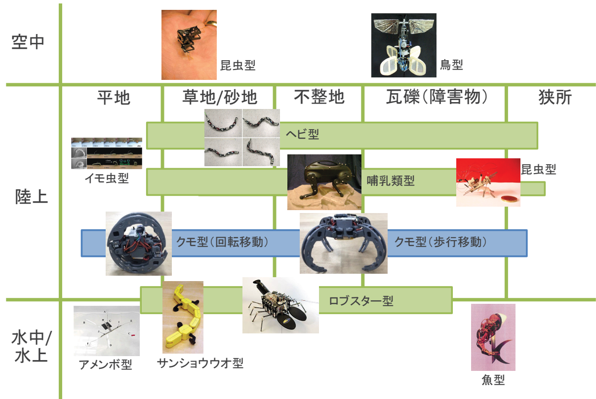
図 1.1: 生物に着想を得たロボット [1, 2, 3, 4, 5, 6, 7, 8, 9, 10, 11]. 陸上, 空中, 水上/水中ごとに様々なロボットが開発されている. クモ型構造可変多脚ロボットは陸上の様々な環境に適応可能である.
