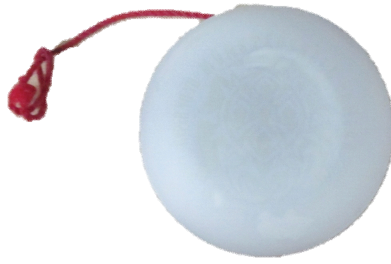
図 2.1: ヨーヨー. 画像処理を用いて重心を検出するために, 市販のヨーヨーを白く塗って使用する.
